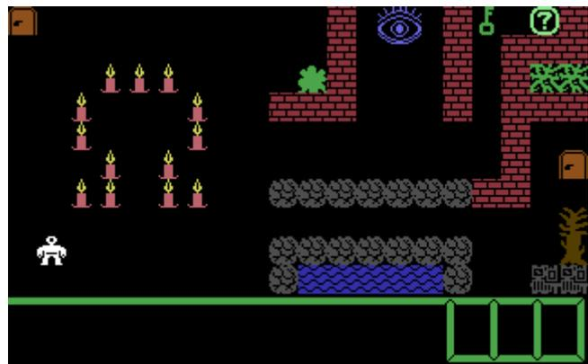
Damit der **MAP**-Zeichensatz auch alphanumerische Zeichen für Beschriftungen und Interaktion zur Verfügung stellen kann, ist die Anzahl der 2x2-Objekte auf 48 begrenzt. Sie beginnen bei einem Byte-Offset von 512 Bytes (also ab dem Zeichen mit dem Bildschirmcode 64). Wenn der Zeichensatz z.B. an Position \$E000 im Speicher liegt, beginnen die Objekte daher bei Position \$E200.
